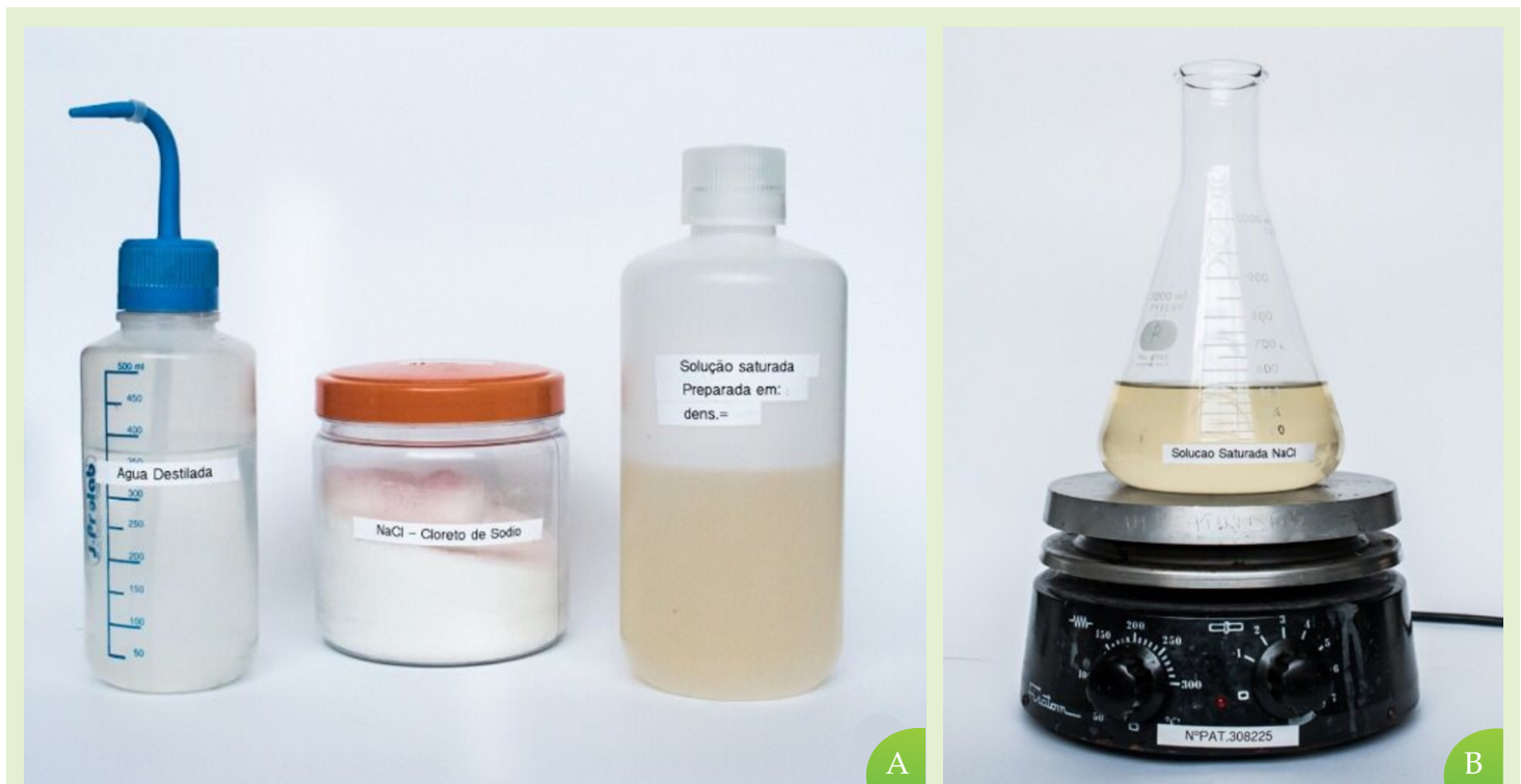
Figura 5. Preparo de solução saturada de cloreto de sódio (NaCl). (A) Materiais necessários para o preparo da solução, da esquerda para direita: água destilada, (quantidade suficiente para: QSP até 1 litro) sal comum (375g de cloreto de sódio, NaCl) e frasco com solução já preparada. (B) Frasco Erlenmeyer com água destilada + NaCl sob agitação mecânica por 10 minutos para homogeneização da solução (Fotos: LSA Pires e DL Vieira).
